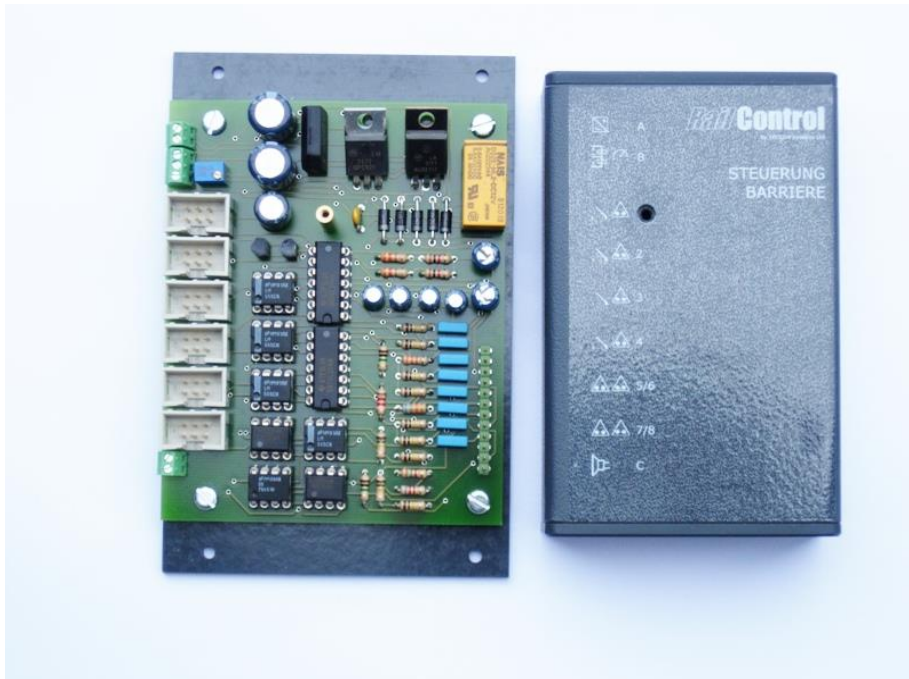
Bild 22 – offene Steuerung ohne Soundmodul (Version 2006)
