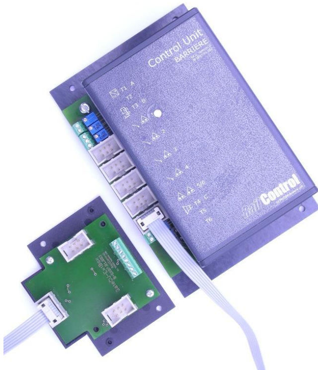
Bild 47 – Extender-Box angeschlossen an Steuerung am Anschluss 5/6
