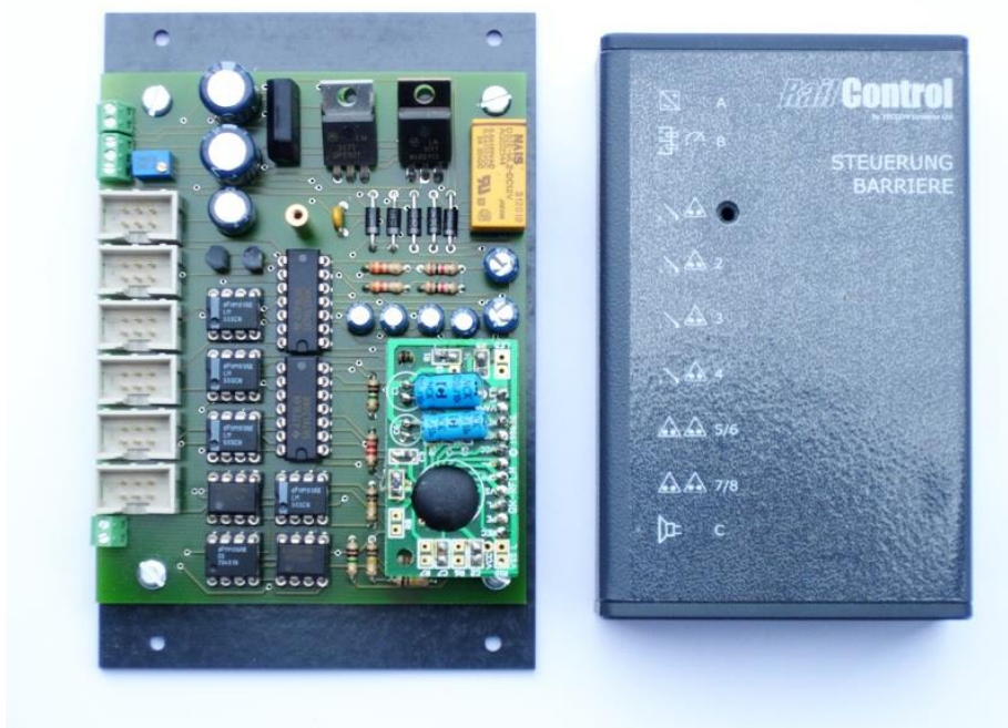
Bild 23 – offene Steuerung mit eingesetztem Soundmodul (Version 2006)
