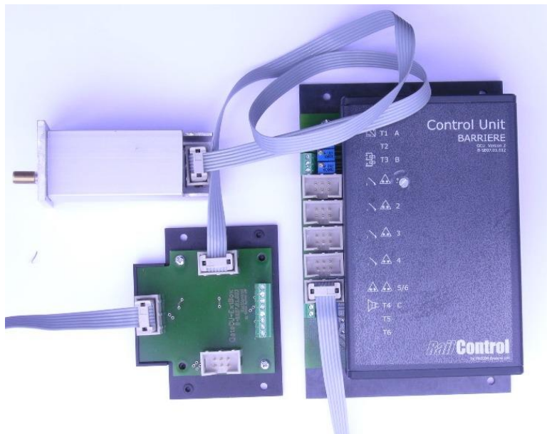
Bild 48 – Extender-Box angeschlossen an Steuerung mit Signalanschluss
