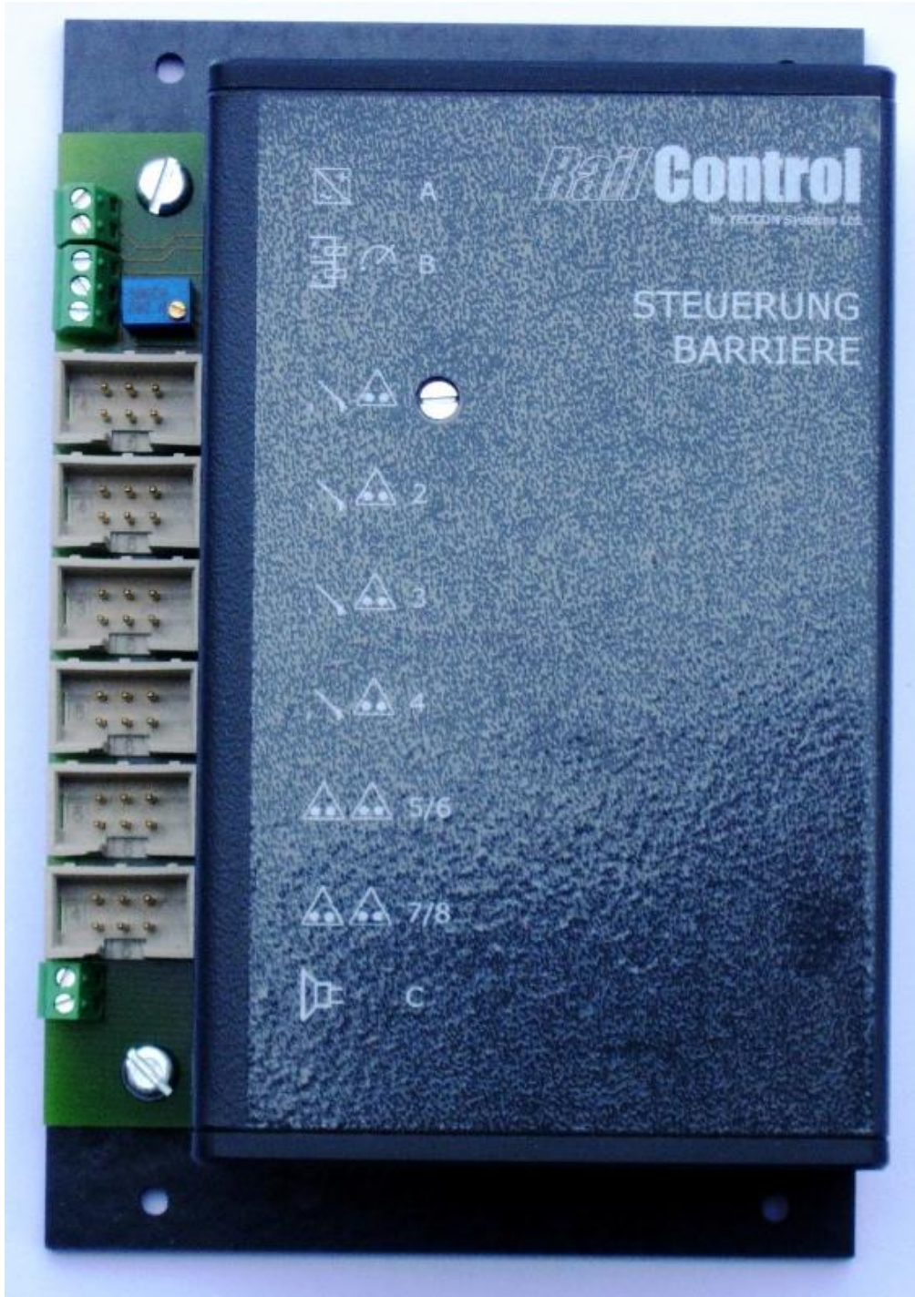
Bild 21 – geschlossene Steuerung (Version 2006)
