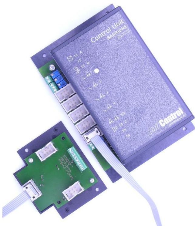
Bild 47 – Extender-Box angeschlossen an Steuerung am Anschluss 5/6
