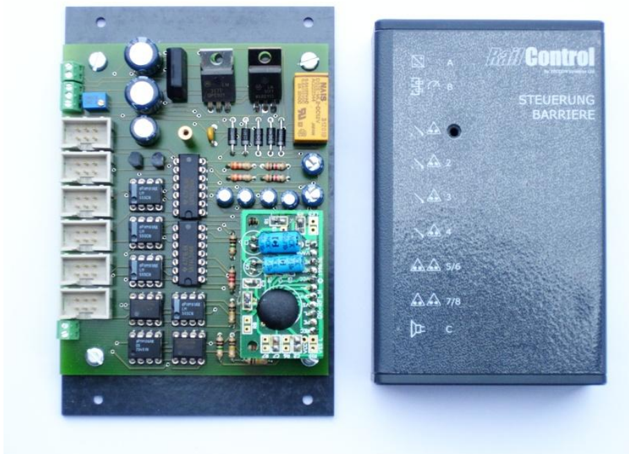
Bild 23 – offene Steuerung mit eingesetztem Soundmodul (Version 2006)
