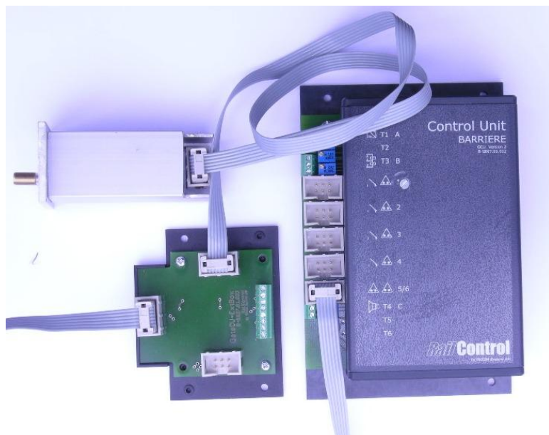
Bild 48 – Extender-Box angeschlossen an Steuerung mit Signalanschluss
