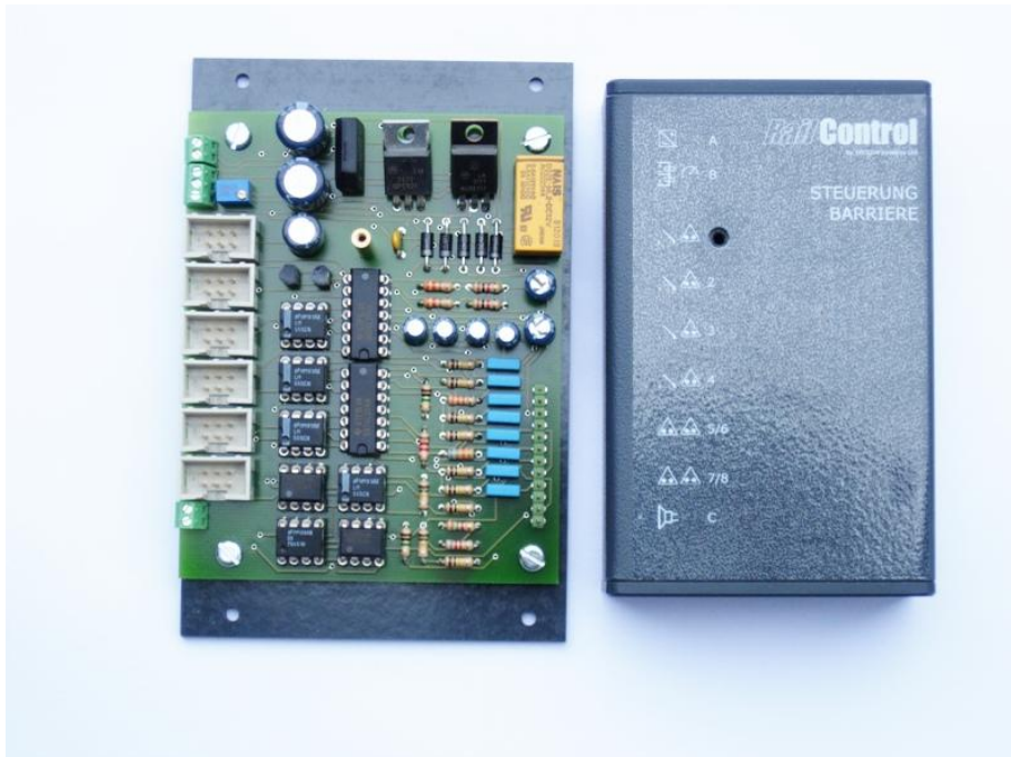
Bild 22 – offene Steuerung ohne Soundmodul (Version 2006)
